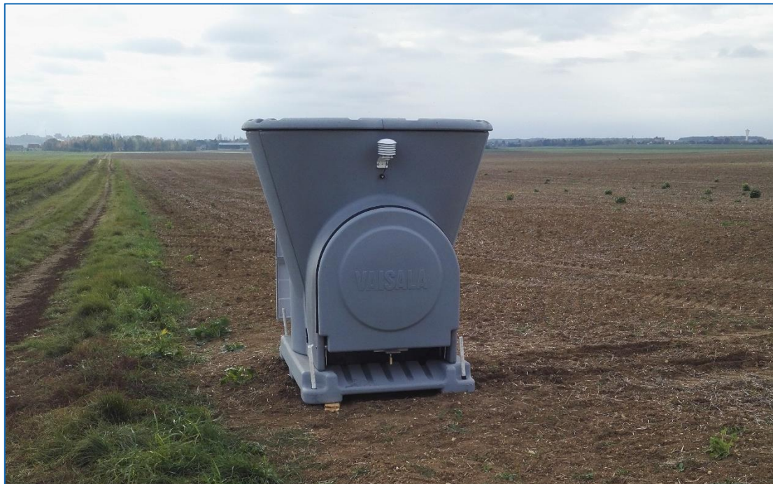
Figure 16 : SODAR installé à Beaumont-du-Gâtinais (Source Innergex)
